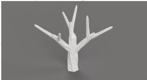
Wenn ein 3D-Modell deutliche Überhänge besitzt, brauchen Sie beim Druck **Stützmaterial (Support Material)**. Die Äste dieses Baums zum Beispiel ragen seitlich über den Baumstamm hinaus. Der 3D-Drucker kann aber diese Äste nicht in der Luft drucken; er hat nichts, worauf er sein Druckmaterial ablegen könnte. Deshalb wird während des Druckvorgangs Stützmaterial unter den Ästen mitgedruckt. Auf diesem Stützmaterial können die Äste problemlos gedruckt werden.
