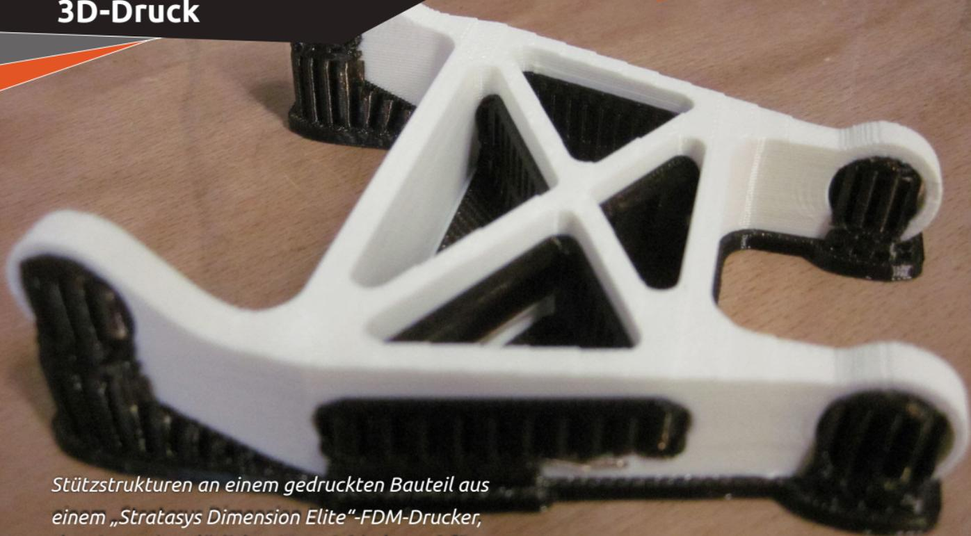
*Stützstrukturen an einem gedruckten Bauteil aus einem „Stratasys Dimension Elite“-FDM-Drucker, der ein zweites, lösliches Material (schwarz) für den Support verwendet. Es wird anschließend in einer Seifenlauge ausgewaschen.*
