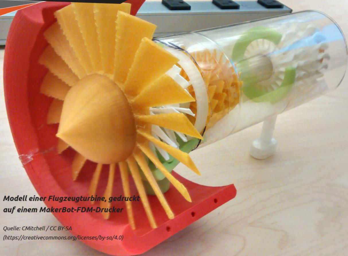
***Modell einer Flugzeugturbine, gedruckt
