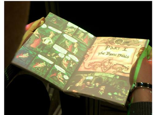
**Technik.** Im Inneren des TWEND-Buchs messen sechs Sensoren, wie stark sich eine Seite verbiegt. Diese Daten werden live an einen Rechner gesendet, der Störungen herausfiltert und dann die *Biegegeste* identifiziert — beispielsweise, dass die rechte obere Ecke leicht nach vorne gebogen wurde. Er schickt ein passend animiertes Bild der Buchseiten an den Projektor, der es von oben zurück auf das Buchmodell wirft.
