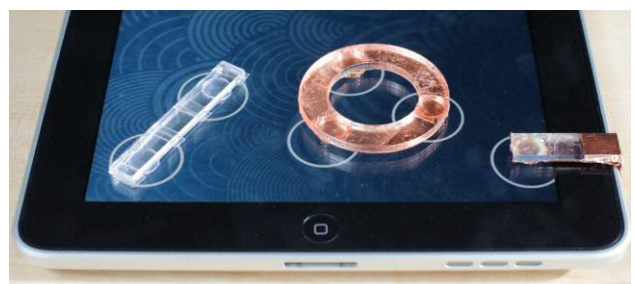
図1 iPad上のPUCs widget。ブリッジマーカでの実装(左)とリングマーカでの実装(中央)。右はiPadの適応的なフィルタを無効化するためのタッチ点。
